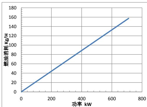
以上所有的数据都是基于或修正至SAE J1995标准规定的条件——海拔90m (300ft.)，大气压力100kPa (29.61in.Hg)，进气温度25°C (77°F)，水蒸汽压力1.0kPa (相对湿度30%)，使用美国标准2#柴油。
